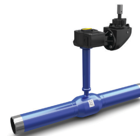
GLOBTOS W PEŁNI SPAWANE ZAWORY KULOWE, DO PREIZOLACJI, TRZPIEŃ SZEŚCIOKĄTNY, ZREDUKOWANY PRZEPŁYW, DN 25 - DN 400
